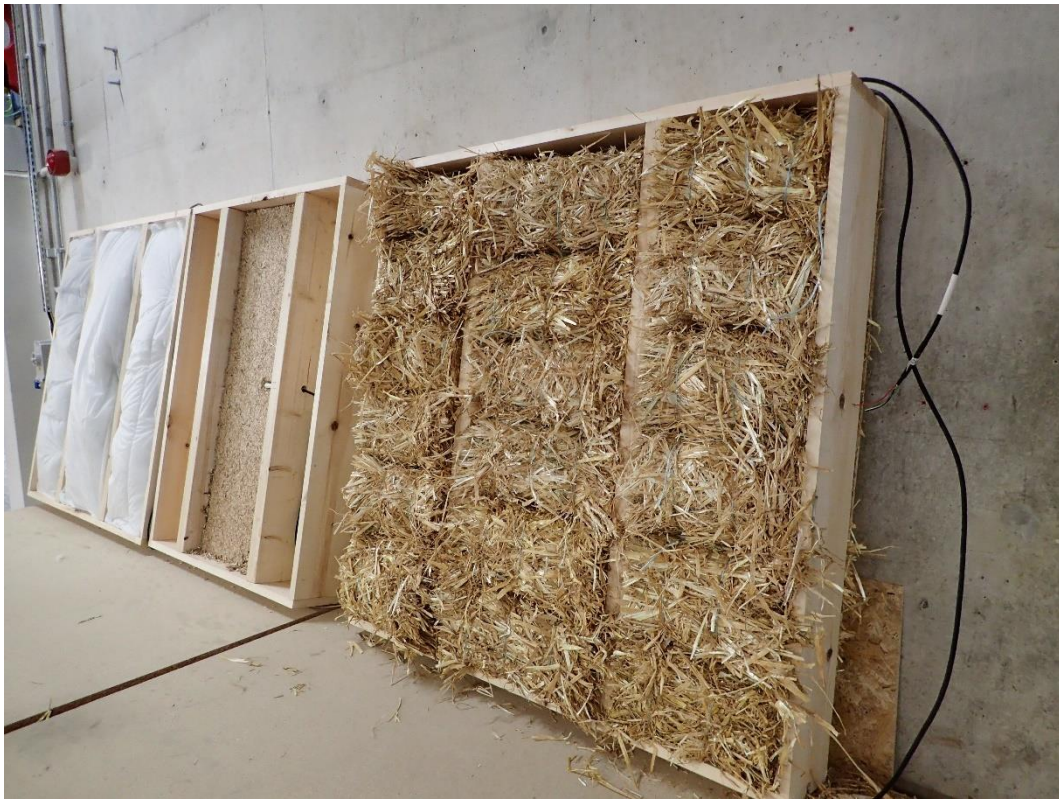
Figure 3: Photos des 3 prototypes à taille réelle tels que déployés dans la Grande Chambre Climatique du partenaire Université de Bath.
