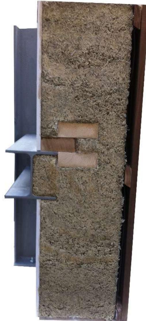
C'est un béton léger, isolant et respirant, constitué de paillettes de chènevotte et de chaux
