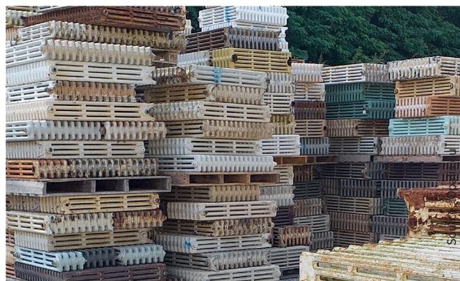
Une étape de la chaîne de remise en état des radiateurs en fonte.
