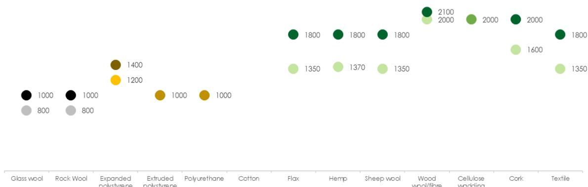
Figure 17: Capacité thermique (minimale, maximale) en J.kg-1.K-1 de l'isolation des combles conditionnée en rouleaux et en panneaux (Nomadéis, 2021).
