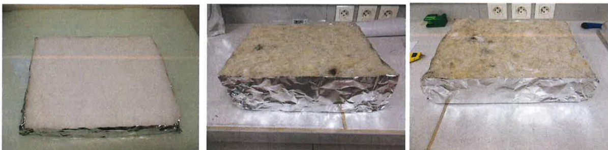
Figure 4 : Eprouvettes d'essai (Prototypes 1, 2 et 3) après découpe et colmatage
