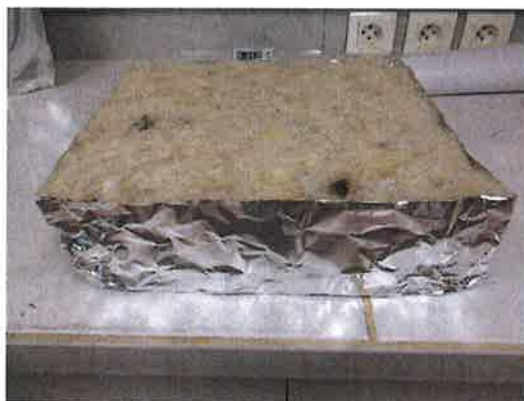
Exemple d'éprouvette d'essai après découpe et colmatage / Test piece's example after cutting and sealing
