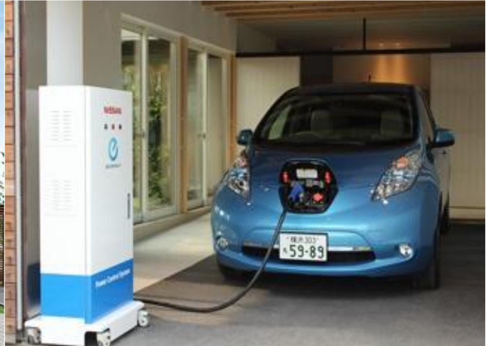
La batterie lithium-ion de la Nissan Leaf est capable de stocker jusqu'à **24 kW/h** d'électricité, quantité d'énergie suffisante à l'alimentation d'un foyer japonais moyen pendant environ **48 heures**
