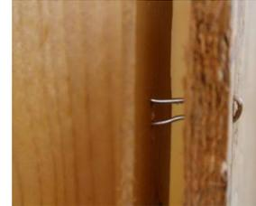
La comparaison du comportement dynamique des murs avec panneaux OSB en 12 mm, agrafés et pointés, montre que les déplacements en tête de mur sont semblables lors des essais sur table vibrante (cf. illustration 6). De plus, la limite de non effondrement de ces deux types de mur est proche.
