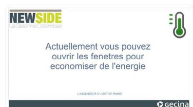
conditions climatiques. Le message diffusé indique aux occupants si il y a besoin d'ouvrir ou de fermer les fenêtres, afin d'utiliser au mieux la ventilation naturelle. Les messages proposés sont les suivants :
