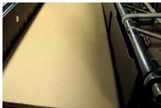
MSL reçoit directement les copeaux de bois, qui sont pressés pour former des panneaux. Source : MSL
